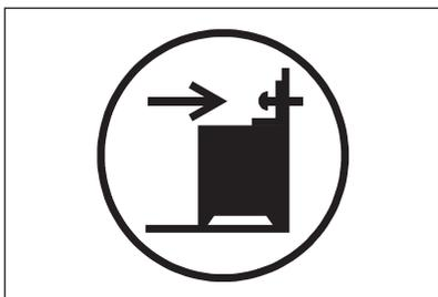
1. Installera tippskyddet 305 - 310 mm nedanför produktens ovansida, och med 80-85 mm avstånd från produktens sida till det runda hålet på konsolen. Skruva fast den i det fasta materialet eller använd lämplig förstärkning (vägg).
