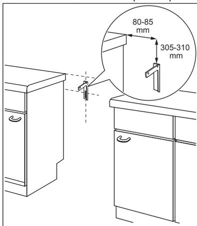
2. Reikä on laitteen takana sen vasemmalla sivulla. Kohota laitteen etuosaa ja aseta laite tilan keskelle kalusteiden väliin. Jos tila kalusteiden välissä on laitteen leveyttä suurempi, säädä sivumittaa voidaksesi keskitää laitteen.
