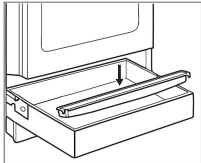
2. Tyhjennä kondenssiveden kerääjä aina ruoan kypsennyksen jälkeen.
