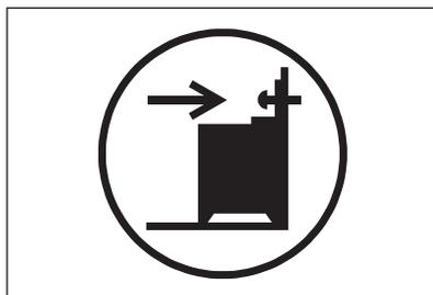
1. Asenna kallistumisenestosuoja 305 - 310 mm laitteen yläpintaa alemmaksi ja 80-85 mm laitteen sivulta olevassa kannattimessa olevaan pyöreään reikään. Ruuvaa se kiinteään materiaaliin tai käytä tarkoitukseen soveltuvaa vahvistetta (seinää).
