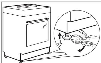
Aseta laitteen ylätaso samalle tasolle muiden pintojen kanssa säätämällä laitteen alla olevia pieniä jalkoja.
