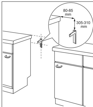
2. Du hittar hålet till vänster på produktens baksida. Lyft produktens framsida och placera den i mitten av utrymmet mellan skåpen. Om utrymmet mellan bänkskåpen är större än produktens bredd måste du justera sidoavståndet till mitten av produkten.
